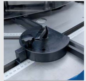
Exakte Winkeleinstellung mithilfe von Anschlägen und Skalen
