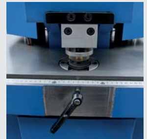
Stanzstation mit 12 Tonnen Stanzdruck an der Rückseite
