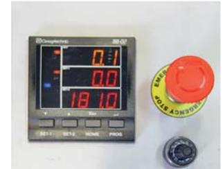
Einfache Bedienung, mit digitaler Anzeige für aktuelle Biegewerte und zum Setzen der Parameter
